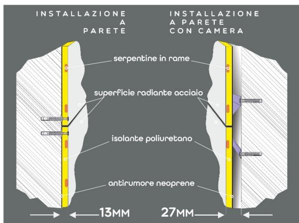
I pannelli radianti, hanno lo stesso spessore del comune cartongesso e una volta posati possono essere rivestiti con materiali di rivestimento quali gres, ceramica, cartongesso (incollato al pari di una piastrella di gres) o rasati interponendo apposita rete per rasatura.
